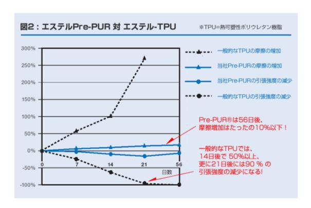
ポリエステル-ポリウレタンの化学的分解の過程が、しばしばポリエステル鎖の加水分解によることから、80°Cの熱水での加水分解テストも適切な尺度となります。上図は、当社エ
